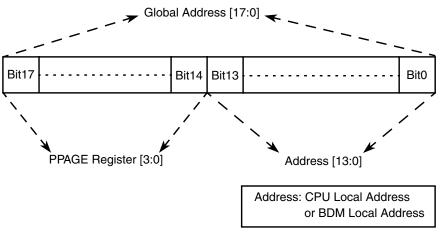
Figure 3-9. PPAGE Address Mapping
